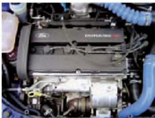
▲ Figura 12.29 Motores de plástico. El múltiple de la entrada de admisión de algunos motores Ford está formado de nylon.
